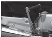
заправочная горловина масла в картер двигателя
