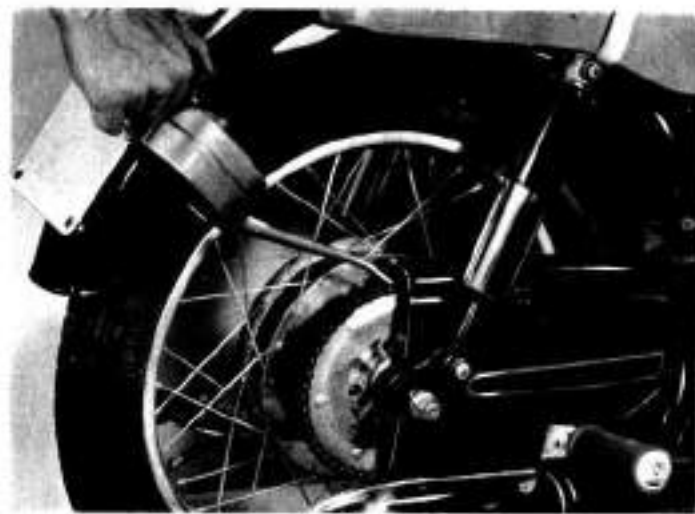
Рис. 53. Смазывание цепи маслом
