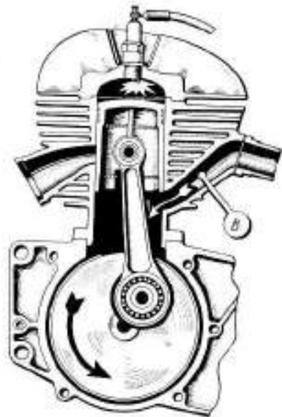
Рис. 30. Поршень движется в верхнем направлении
