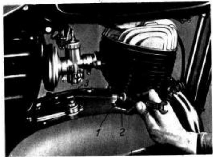
Рис. 46. Установление проволоки муфты сцепления
