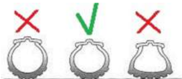
Визуальная оценка недокаченной или перекаченной шины.
