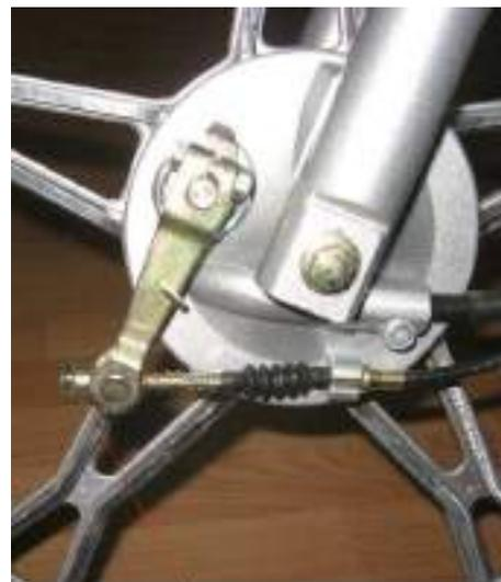
Регулировочная гайка переднего тормоза
