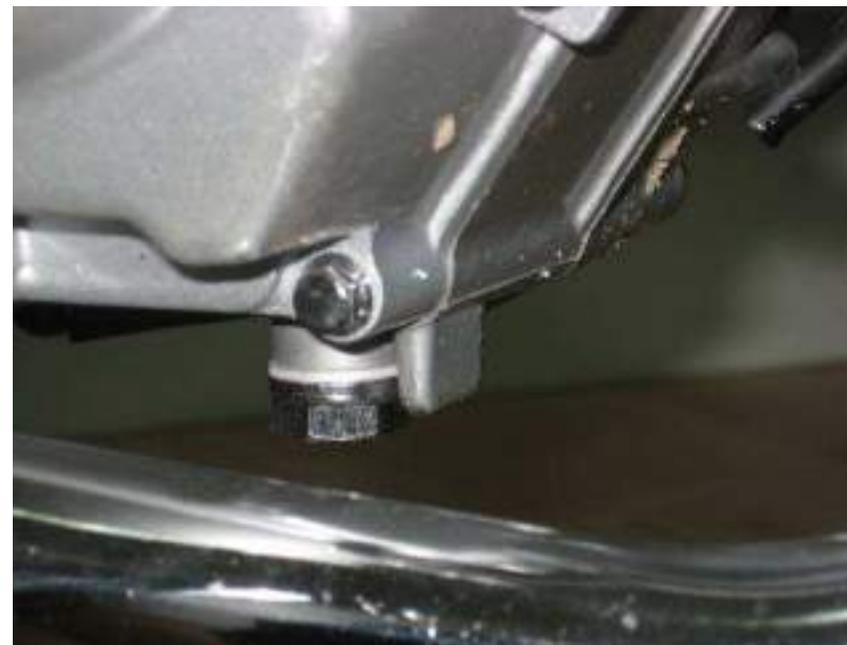
Обратите внимание, что в данной модели мотоцикла коробка передач находится в одном корпусе с двигателем, и, при замене масла в двигателе, одновременно происходит и замена масла в коробке передач.
