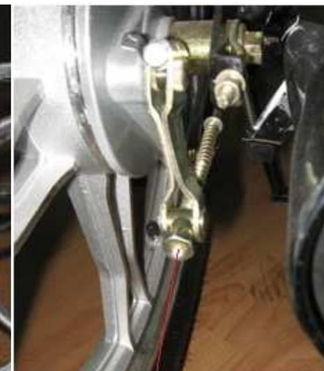
Регулировочная гайка заднего тормоза
