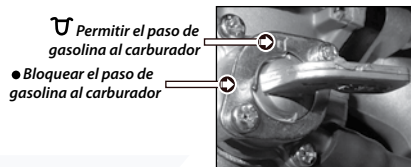
Imagen 9. Válvula de combustible.
