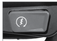
Imagen 3. Interruptor de arranque eléctrico.
