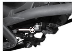
Imagen 16. Ubicación del tornillo de drenado.
