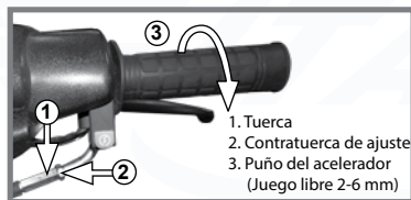
Imagen 20. Ajuste del puño del acelerador.
