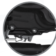
Imagen 16. Ubicación del tornillo de drenado.
