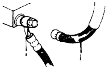
(цурење, оштећења, лабавост кочione цеви)
