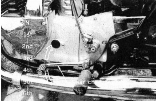
Fig. 60 Foot shift lever
